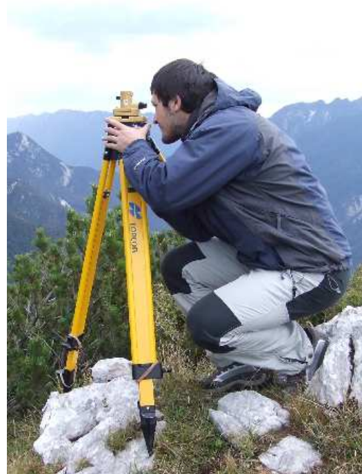
Figura 42: controllo dell'allineamento del centro dell'antenna GPS con il caposaldo a terra.
