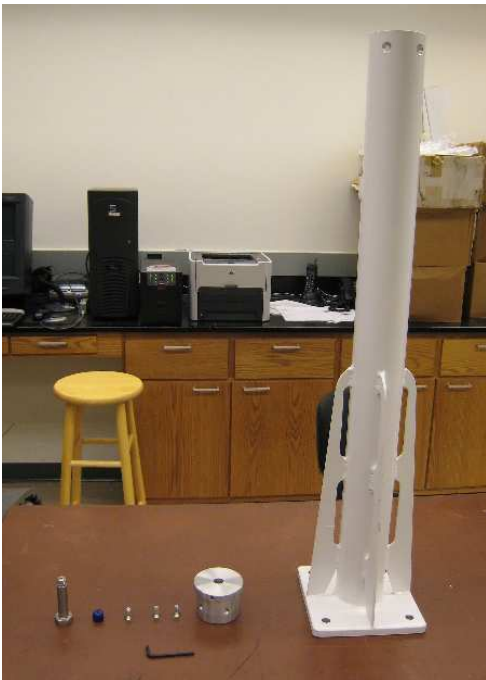
Figura 60: parti del monumento GPS MAST , il sistema comprende pochissime parti.
