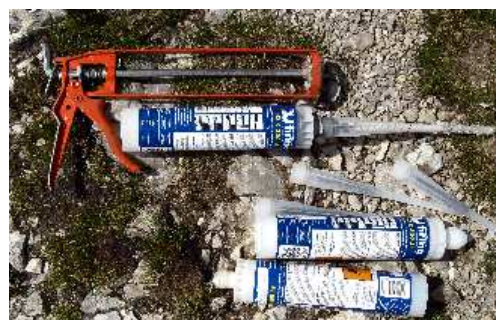
Figura 67: colla bicomponente e pistola per l'iniezione.
