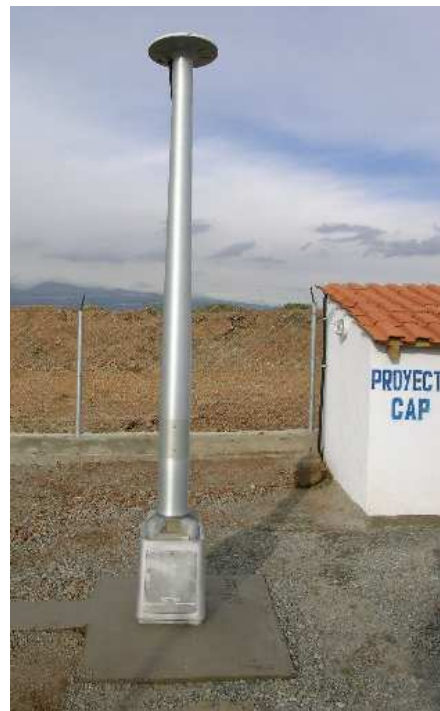
Figura 63: il GPS MAST può avere diverse altezze: in figura un modello da 2m, sulla base è presente l'alloggio per un ricevitore GPS.
