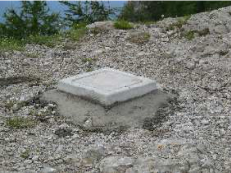
Figura 68: sequenza di operazioni eseguite per l'installazione del caposaldo per monumentazioni su roccia tipo "POLIMI".
