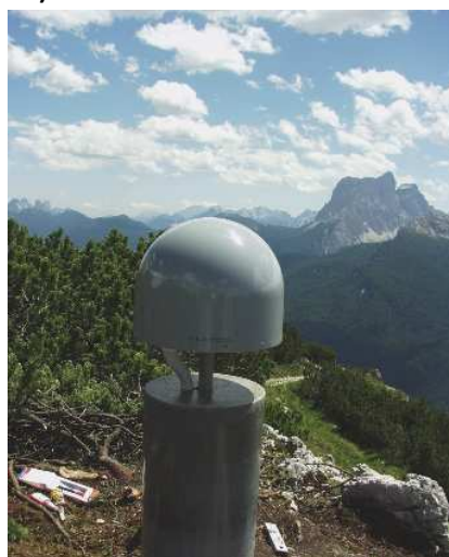
Figura 53: la stazione GPS permanente di Alpe Faloria (AFAL).
