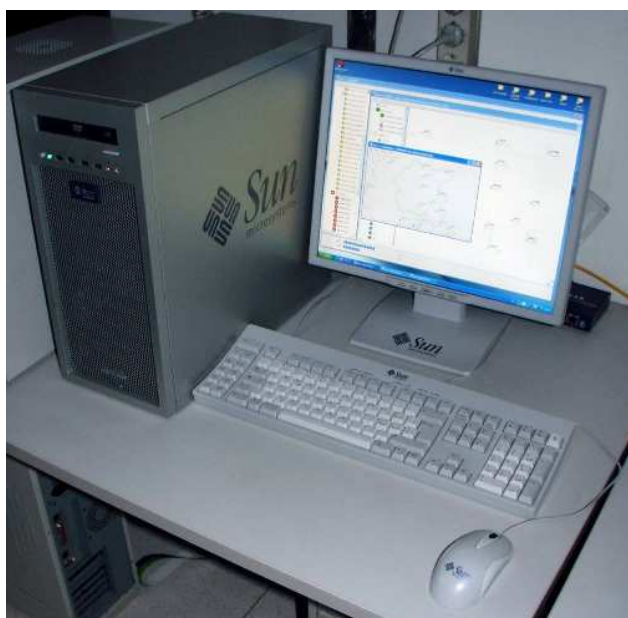
Figura 1: server RTK, per il calcolo e la distribuzione delle correzioni differenziali in tempo reale.
