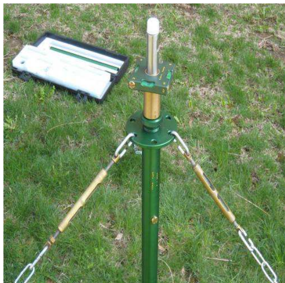
Figura 57: fase di montaggio del monumento. La messa in bolla è l'unica regolazione permessa all'operatore.
