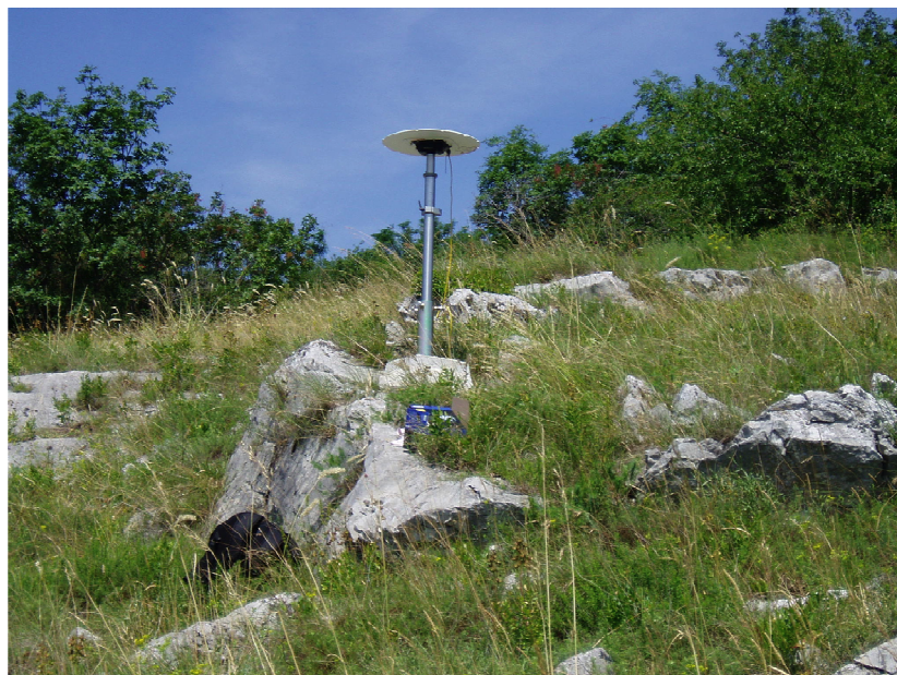
Figura 55: il pilastro per lo stazionamento dei punti della rete GPS non permanente.
