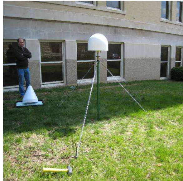
Figura 59: TECH2000 in opera, è stata fissata anche l'antenna GPS all'interno della cupola bianca.
