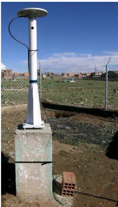
Figura 62: GPS MAST installato.
