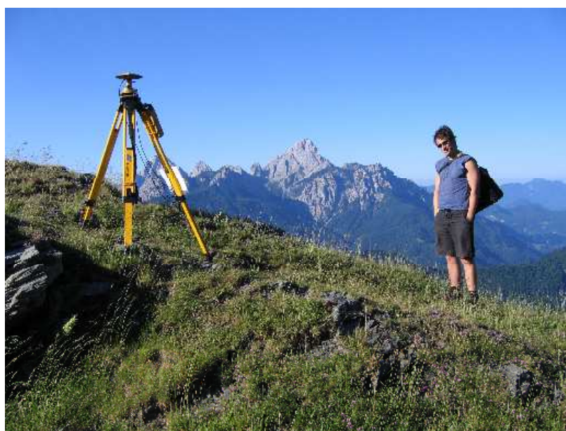
Figura 39: fase di acquisizione dati GPS durante la campagna dell'anno 2006. La misura si riferisce al caposaldo situato nei pressi di Malga Pizzul (codice caposaldo PIZ1).
