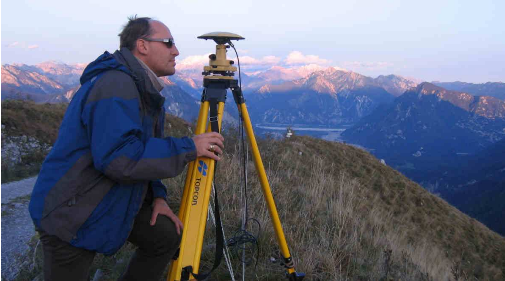
Figura 40: controllo della messa in bolla dell'antenna GPS.
