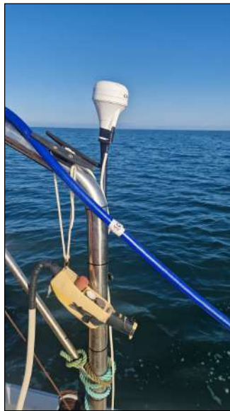
Figura A.6 - GPS installato sull'imbarcazione.
