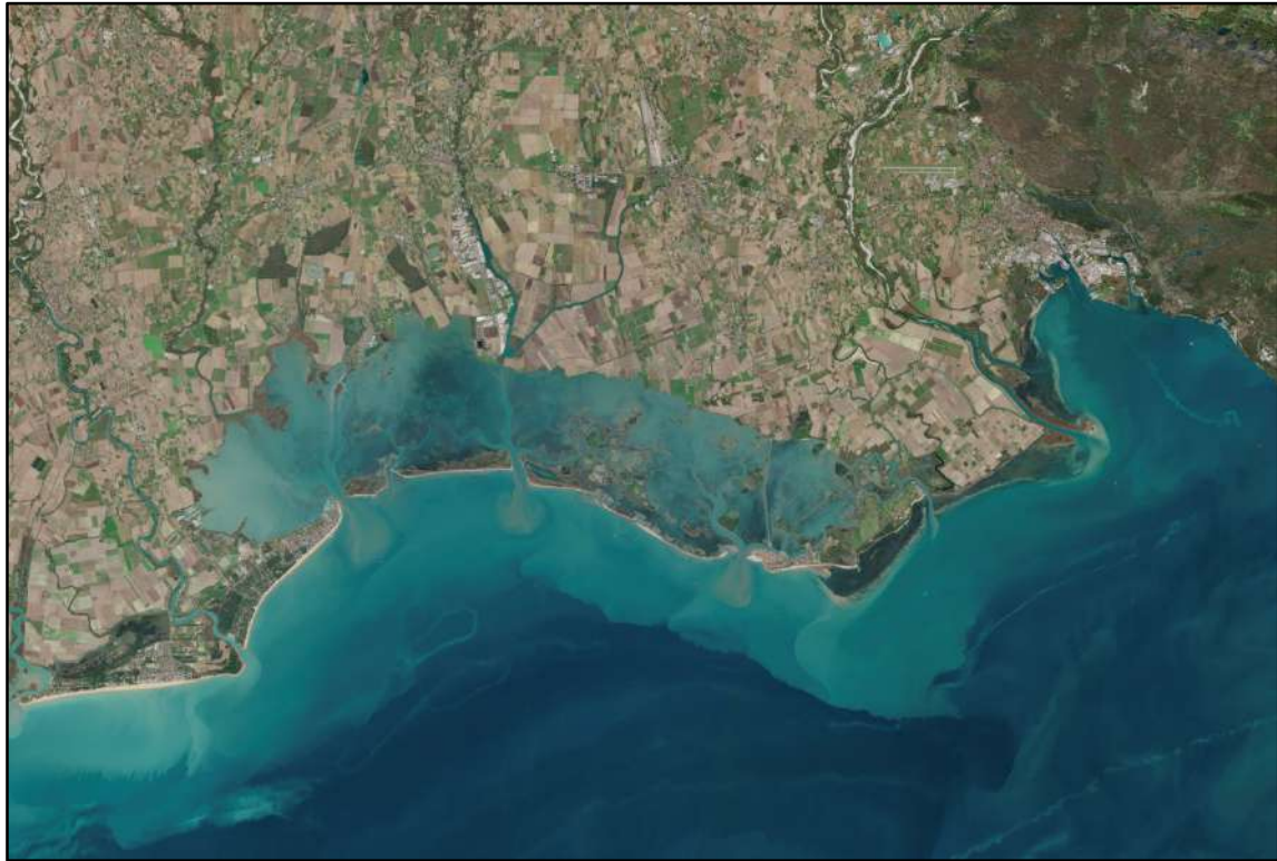
Figura 3.17 – Immagine satellitare Sentinel-2 L2A, acquisita in data 15/11/2024, nella quale è visibile la dispersione dei sedimenti in prossimità delle bocche lagunari e lungo la costa.
