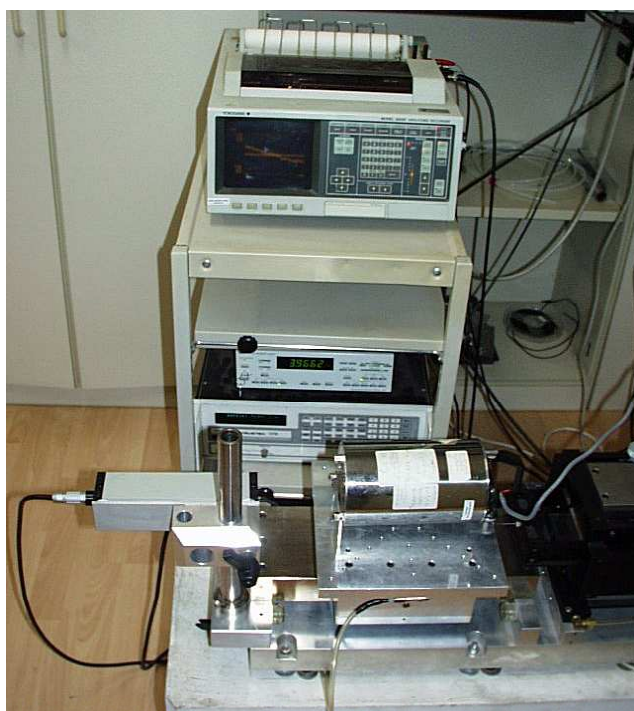
Figura 1.5: Un sensore Willmore durante la fase di taratura della componente orizzontale.
