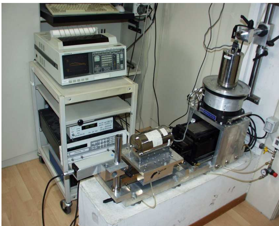
Figura 1.3: Visione globale della tavola vibrante, con due sensori Willmore posizionati per la calibrazione della componente orizzontale (al centro) e verticale (a destra).
