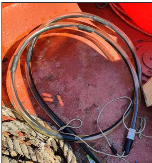
Figura 6: Streamer monocanale Geo Sense. Gli idrofoni sono immersi in un gel.
