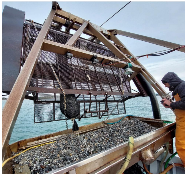
Figura 3.14. Sacco campionatore montato all'interno del cesto della draga idraulica.
