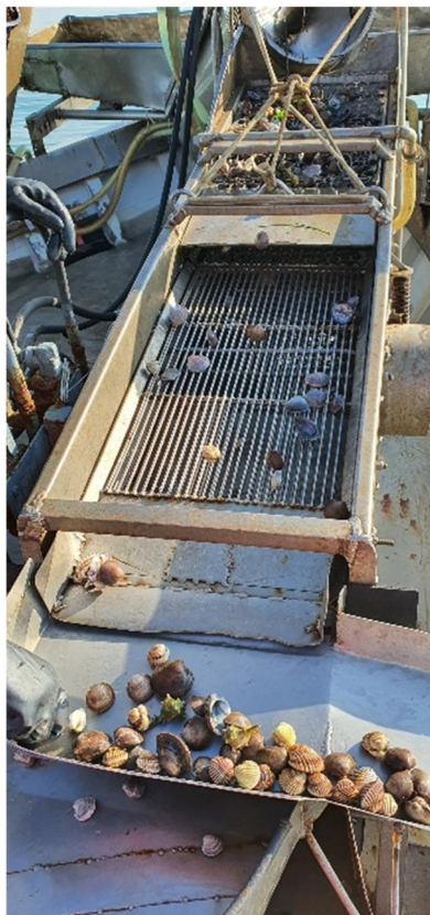
Figura 3.10. Vibrovaglio utilizzato per selezionare a bordo gli organismi catturati dalla draga idraulica.
