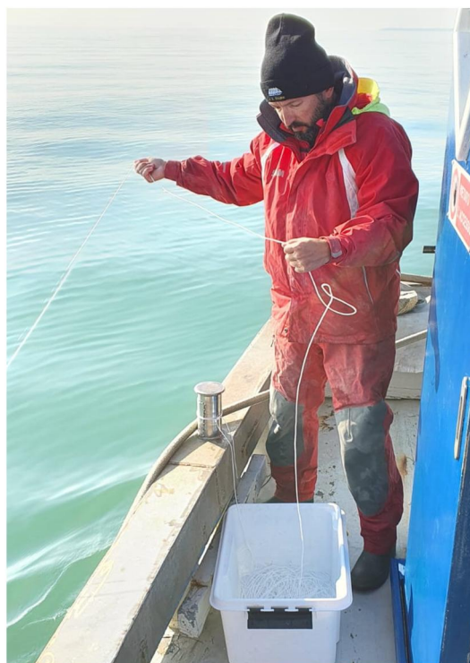
Figura 3.8. Sagola di 100 m filata in mare per misurare con precisione la lunghezza della cala effettuata con la draga idraulica.
