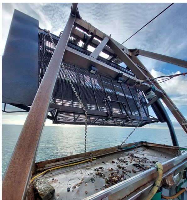
Figura 3.7. Cesto metallico per la raccolta dei bivalvi nella pesca con draga idraulica (vogolarà).
