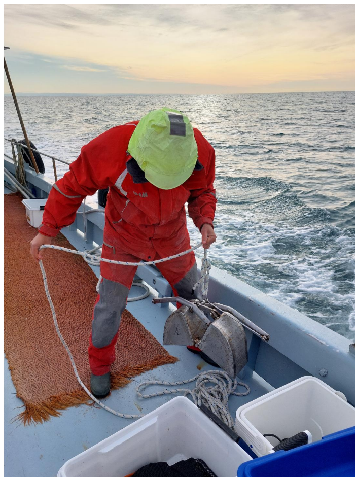
Figura 3.6. Benna Van Veen “armata” e pronta per essere calata fuori bordo.
