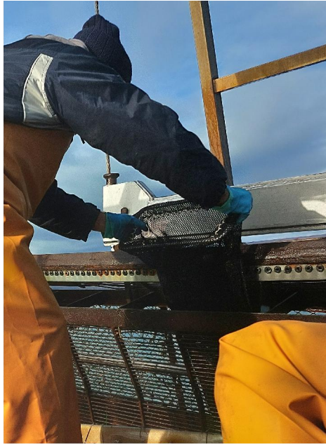
Figura 3.13. Collegamento della bocca del sacco campionatore sulla bocca del cesto della draga idraulica.
