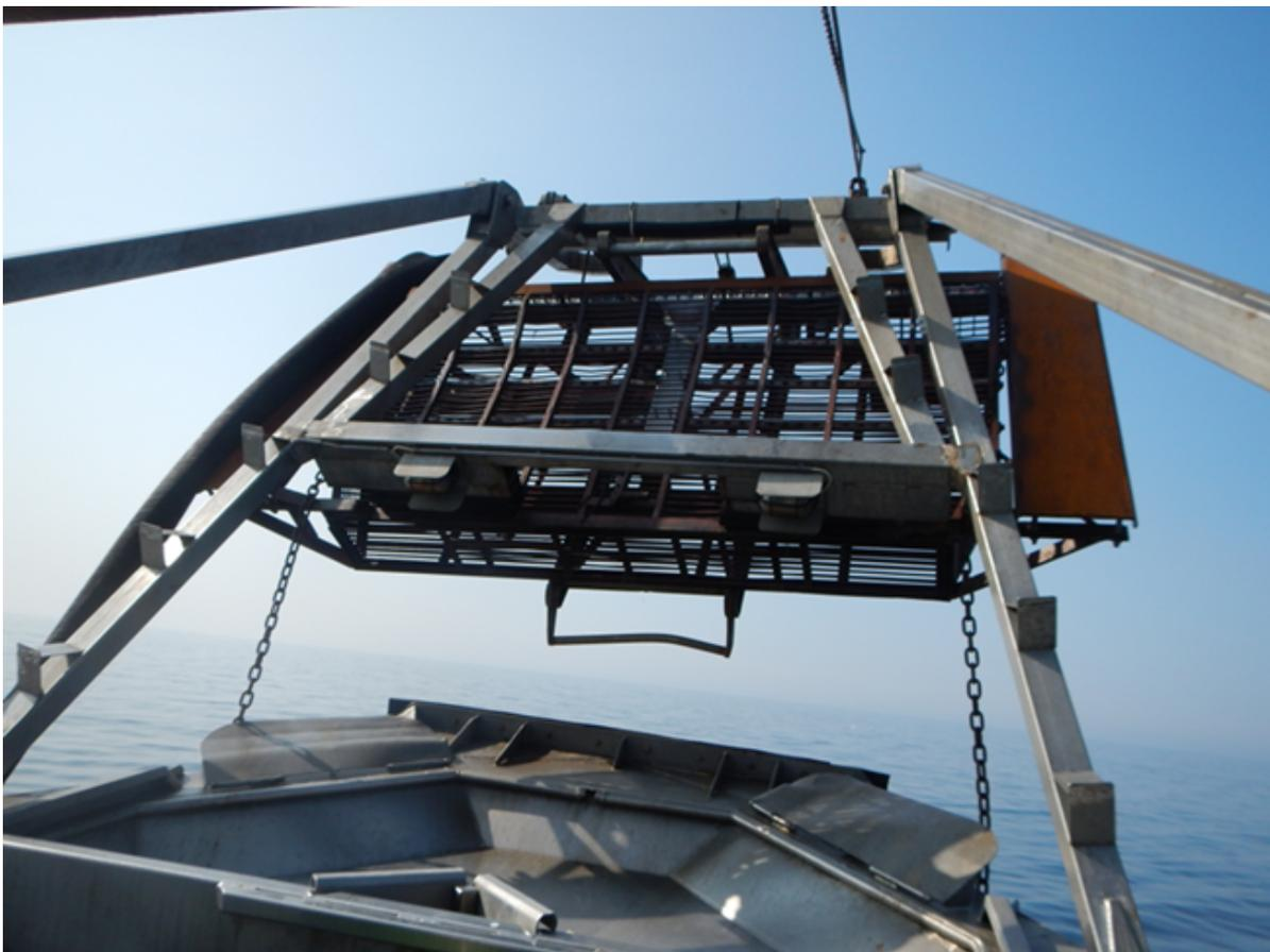
**Figura 3.1.2.** Cesto metallico per la raccolta dei fasolari (*Callista chione*) montato a prua dell'imbarcazione equipaggiata per la pesca dei molluschi bivalvi con draga idraulica.
