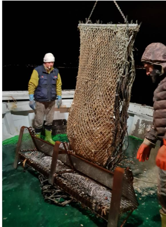
*Figura 5.1.2. Recupero del rampone a seguito della cala a strascico.*
