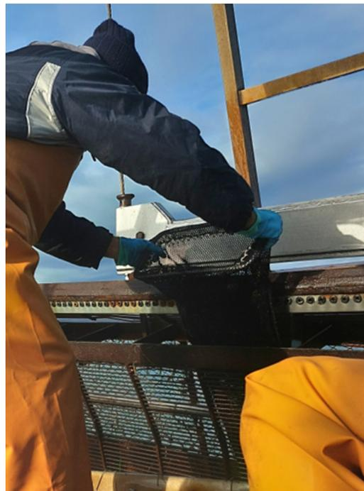
**Figura 3.2.2.** Fase montaggio del sacco campionario sulla bocca del cesto di una draga idraulica.
