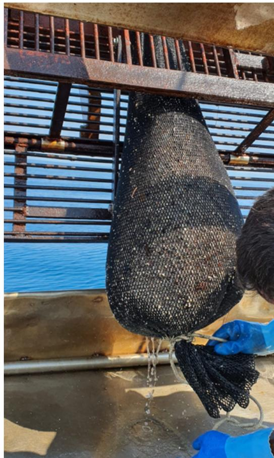
**Figura 3.4.1.** Recupero e svuotamento del sacco campionatore applicato sulla bocca del cesto di una draga idraulica utilizzata sulle 30 stazioni, secondo il metodo descritto nel capitolo 3.2.
