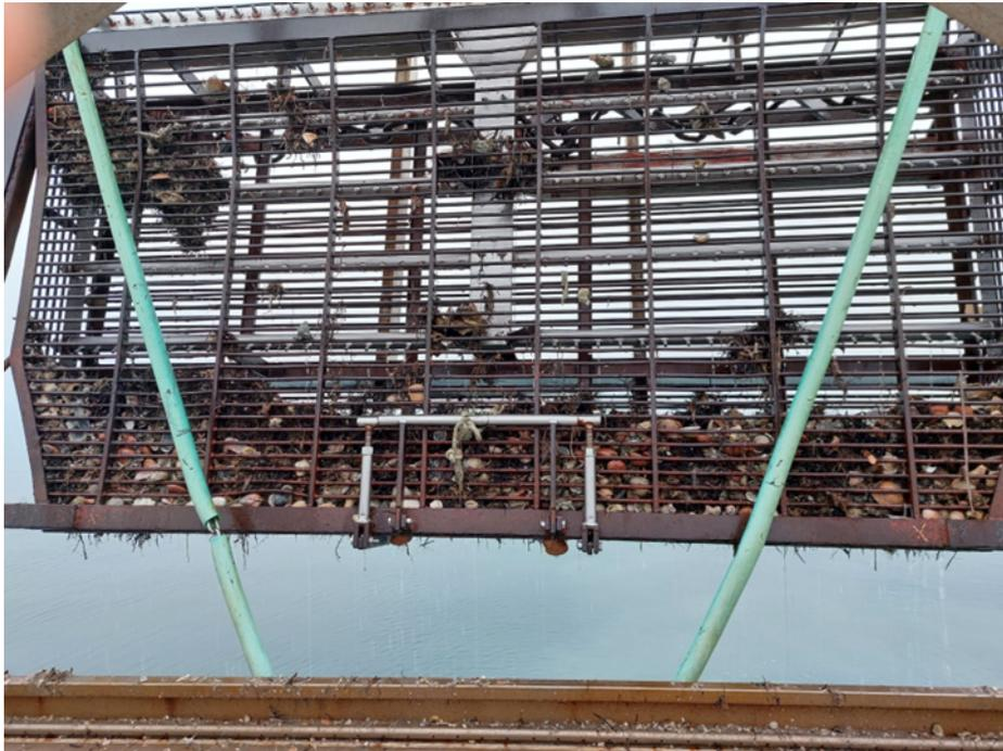
**Figura 3.3.1.** Recupero del cesto di una draga idraulica, appena prima che il contenuto venga svuotato nella vasca di raccolta posta a prua dell'imbarcazione.
