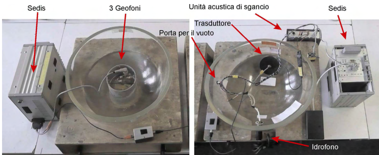
Figura 3-2 OBS in laboratorio: le due semisfere di vetro e le componenti principali.
