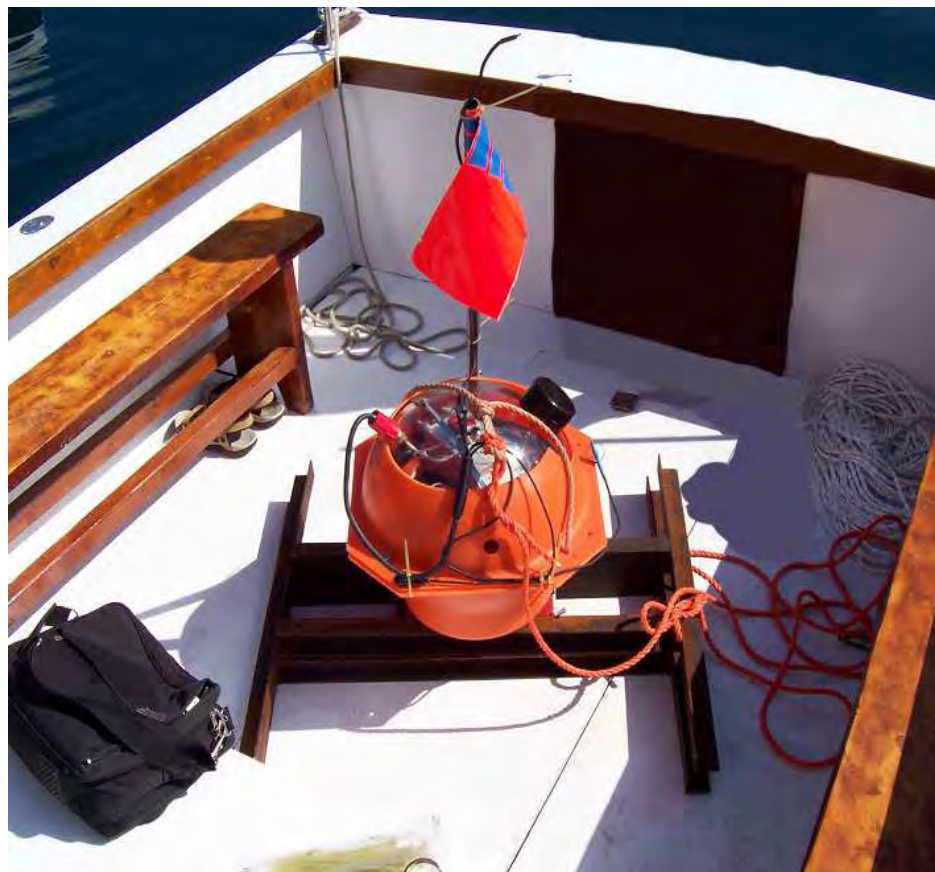
Figura 3-1 OBS con zavorra pronto per essere calato in mare.
