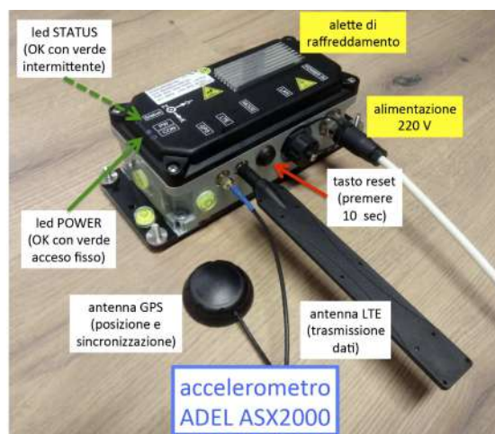
Figura 2.2: Accelerografo ADEL ASX2000 utilizzato per la rete accelerometrica del Veneto.
