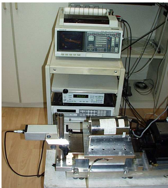
Figura 1.5: Sismometro durante la fase di taratura della componente orizzontale.
