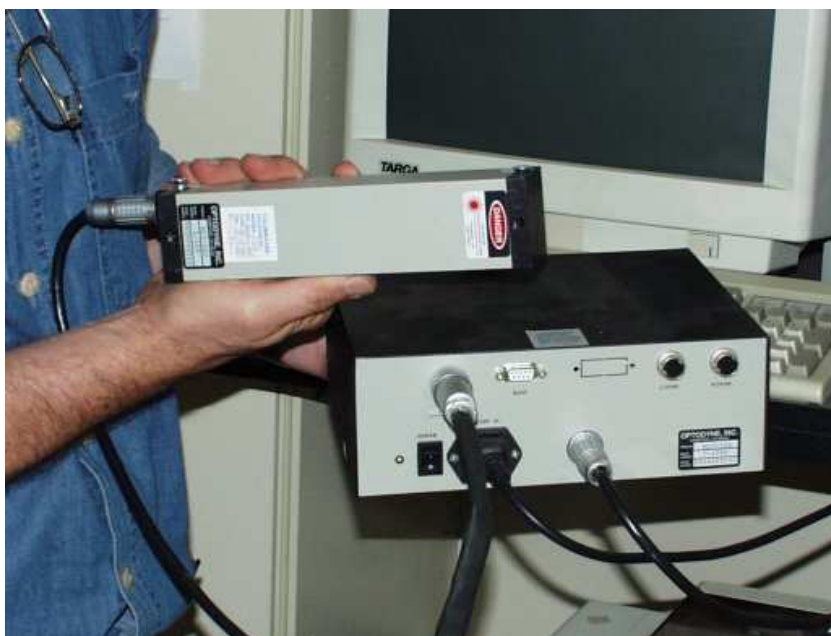
Figura 1.4: Sensore laser di spostamento (Laser Doppler Optodyne).
