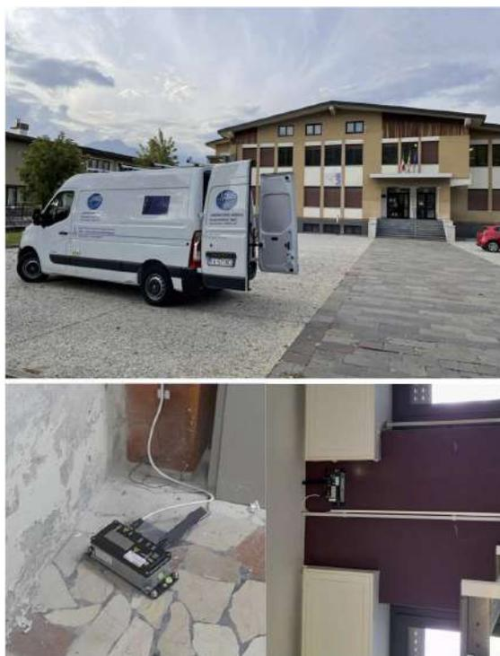
Figura 6.3: Installazione di due accelerometri presso un edificio comunale a Lentiai, comune di Borgo Valbelluna (BL)
