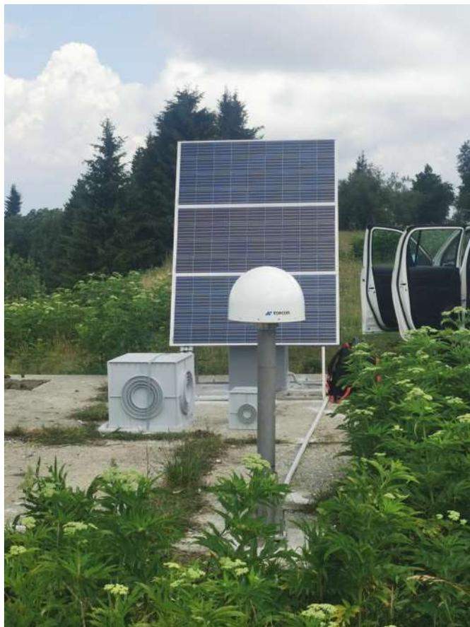
Figura 2.4: Nuova stazione sismometrica del Monte Grappa sul Col di Buratto, sigla MGBU. Sullo sfondo armadio elettrico e pannello solare; più avanti le scatole con i sensori (a sx il sismometro, a dx l'accelerometro); in primo piano l'antenna della stazione GNSS facente parte della rete geodetica di OGS FReDNet (stessa sigla MGBU).
