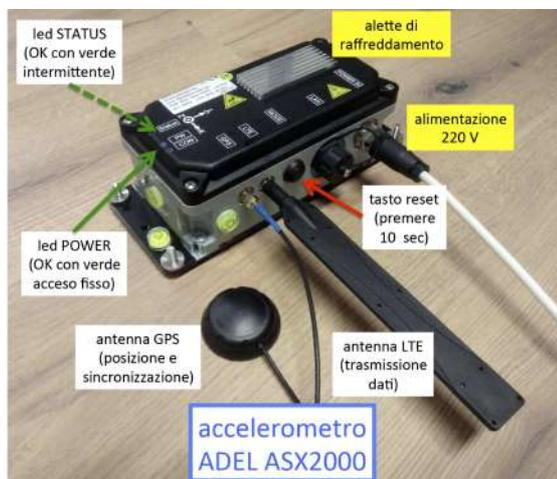
Figura 6.6: Accelerografo ADEL ASX2000 utilizzato per la rete accelerometrica del Veneto
