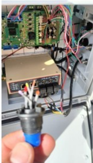
Fig. 1 – Modifiche ai connettori della cassetta IP68
