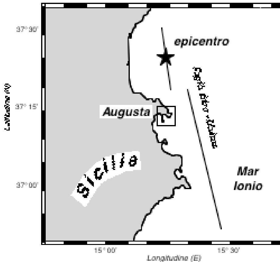
Fig. 7.2 - Mappa generale dell'area di Augusta, con evidenziato l'epicentro usato per la modellazione dell'evento dell'11 gennaio 1693, localizzato sul segmento settentrionale della faglia Ibleo-Maltese. Il rettangolo evidenzia l'area per la quale è stata effettuata la microzonazione, visibile in dettaglio in Fig. 7.3.
