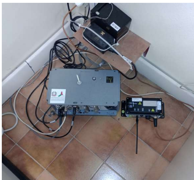
Figura 4. Accelerografo ADEL ASX2000 (scatola piccola a dx, codice stazione FX01) installato a fianco dell'accelerografo Kinematics Obsidian di Pontebba (codice stazione PON).
