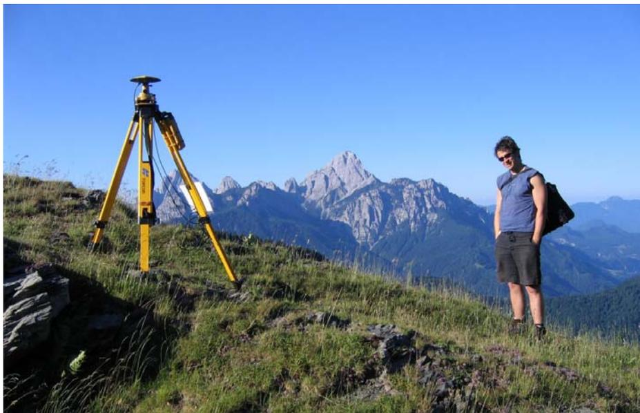
**Fig. 20:** fase di acquisizione dati GPS durante una campagna periodica. L'antenna dello strumento in figura deve essere coassiale con il centrino a terra. La centratura è eseguita tramite la strumentazione ottica posta sulla testa del cavalletto.
