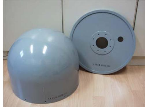
**Fig. 5: cupola protettiva per l'antenna Choke Ring.**
